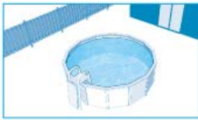
Piscine hors terre clôturée avec échelle munie d'une portière de sécurité qui se referme et se verrouille automatiquement.
