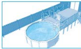
Piscine hors terre clôturée avec terrasse munie d'une enceinte de protection.
