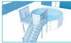
Piscine hors terre clôturée avec plateforme munie d'une enceinte de protection.
